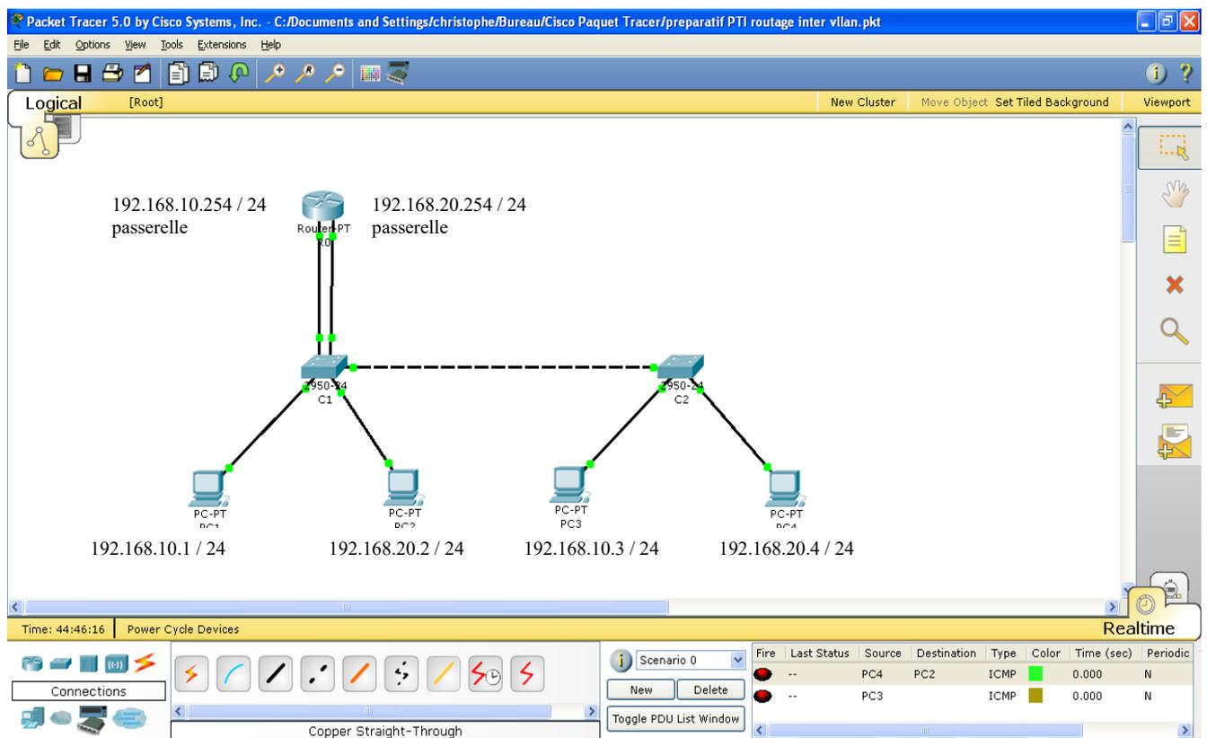
Pour créer un lien sur le port 0/10 et un sur le port 0/11 sur le commutateur C1.
